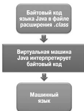
Рис. 11.20. Виртуальная машина Java интерпретирует байтовый код в машинный язык
